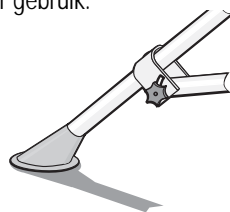
Uitzipoot in gebruik: draaiknop in onderste positie vastzetten.
